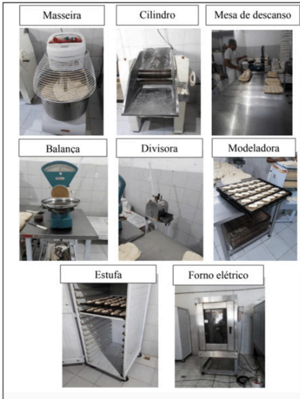
Quadro 1 – Máquinas e equipamentos utilizados na produção do pão francês
